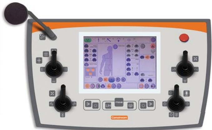
Esta consola fácil de usar cuenta con una pantalla táctil de gran tamaño a color y controles intuitivos. Integra todos los movimientos de la mesa, ajustes del generador y funciones APR en una sola y eficiente interrelación. El auto-posicionamiento facilita la configuración de exámenes, haciéndolos más rápidos.
